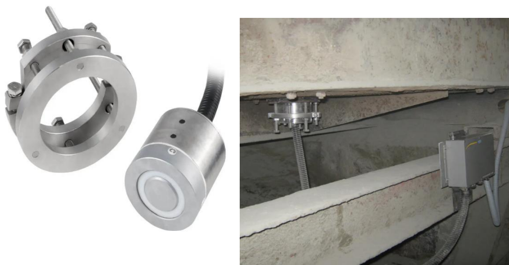
7 - сурет – Бетонды қоспа араластырғышына арналған ылғалдылық өлшеуіш датчигі және оның орналасуы
